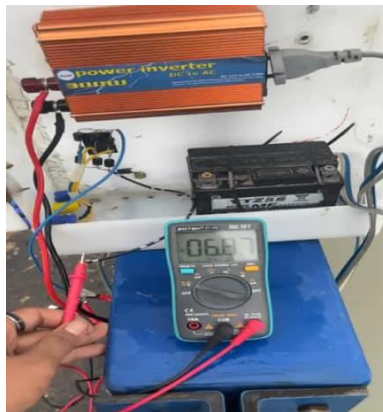
Gambar 10. Pengukuran tegangan keluaran prototipe PLTMH
